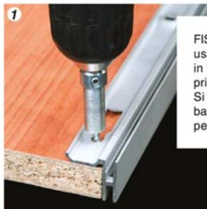
**FISSAGGIO DELLE VITI DIETRO AL PANNELLO:** usando il profilo come dima, posizionare le viti in battuta all'asola e avvitare. Fermare la corsa prima di bloccare il profilo. Si consiglia l'uso dell'inserto a regolazione di battuta **NBA.TULL.ZIN** montato sull'avvitatore per velocizzare questa fase di assemblaggio.
