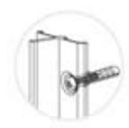
**FISSAGGIO:** i profili sono realizzati per superare la tenuta del tassello a muro (mediamente 350 kg in condizioni ottimali), quindi è fondamentale che l'ancoraggio a parete sia opportunamente eseguito, anche per mezzo di telai quando necessario.
