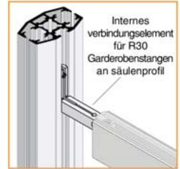
Internes Verbindungselement für R30 Garderobenstangen an säulenprofil
