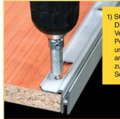
1) **SCHRAUBEN AN DER RÜCKSEITE DES PANEELS BEFESTIGEN:**
